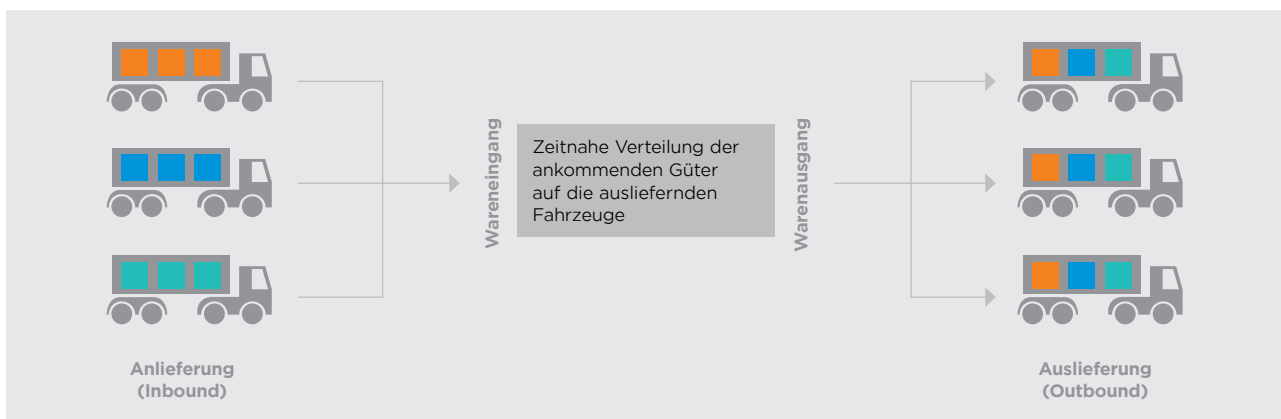
Abbildung 21: Prinzip des Cross Docking
