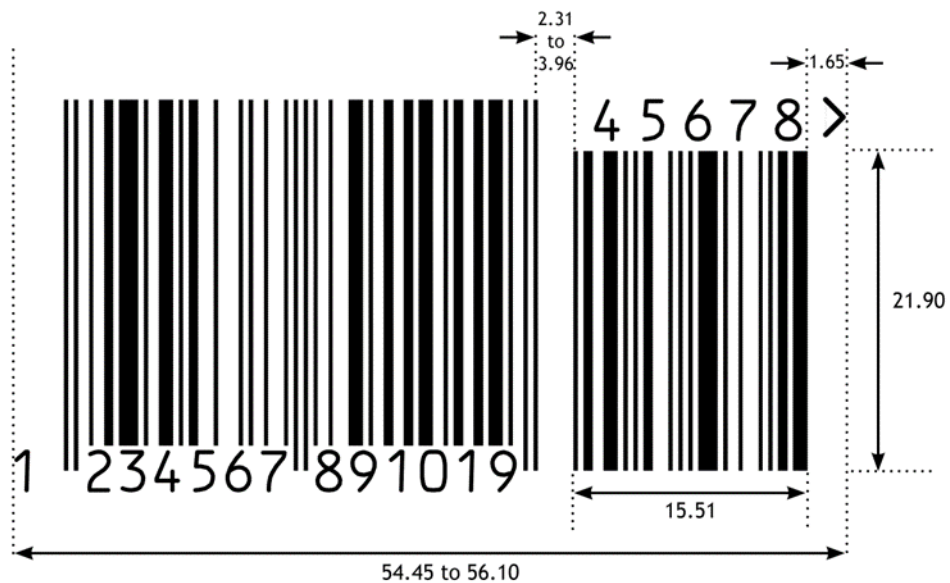
Abbildung 5.2.6.6-6. EAN-13 Strichcode mit fünfstelligem Zusatzsymbol
