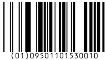
Abbildung 5.5.2.1.1-1. GS1 DataBar Omnidirectional
