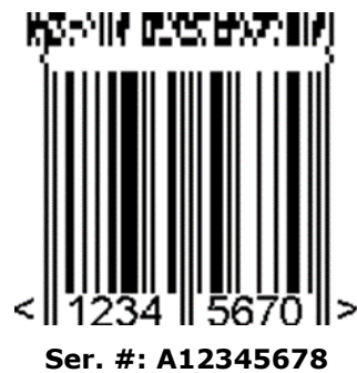
Abbildung 5.11.8-3. EAN-8 Symbol mit einer 3-spaltigen CC-A Komponente
