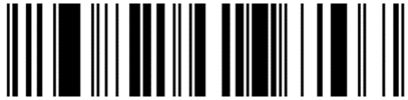
Abbildung 5.5.2.3.1-1. GS1 DataBar Expanded Symbol
