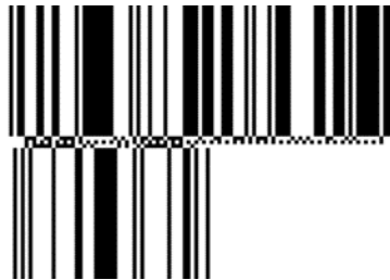
Abbildung 5.5.2.3.2-1. GS1 DataBar Expanded Stacked
