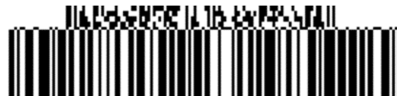
Abbildung 5.11.8-9. GS1-128 Symbol mit einer 4 spaltigen CC-A Komponente
