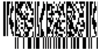
Abbildung 5.11.8-7. GS1 DataBar Limited Symbol mit einer 3-spaltigen CC-B Komponente
