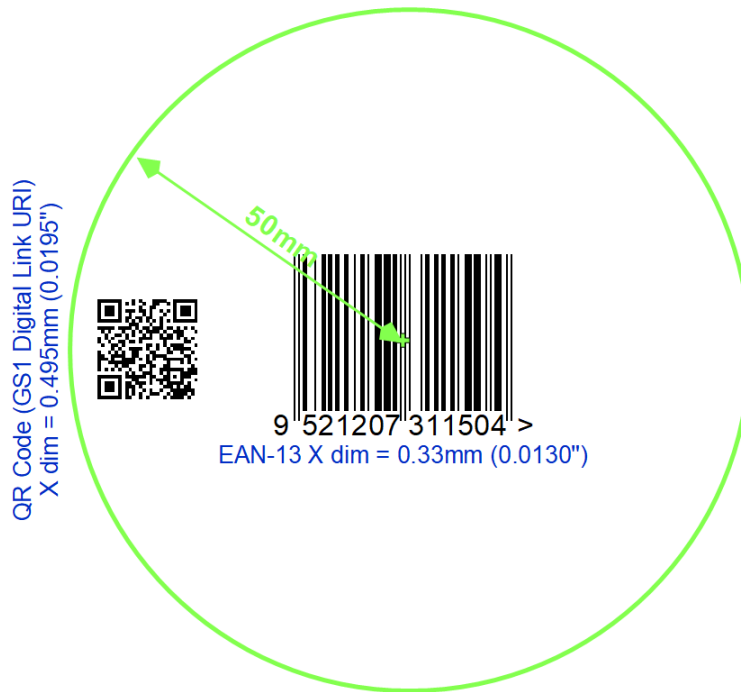
Abbildung 6.3.3.1-1. Platzierung des 2D Codes im Verhältnis zum linearen Strichcode
