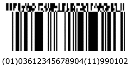
Abbildung 5.11.8-6. GS1 DataBar Stacked Symbol mit einer 2-spaltigen CC-A Komponente
