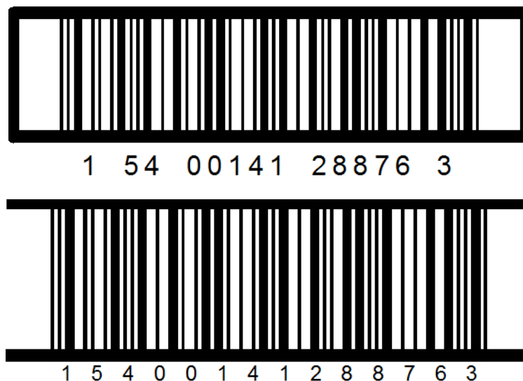
Abbildung 5.3.2.4-1. Beispiele von Trägerbalken
