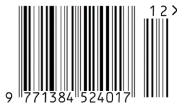
Abbildung 5.2.2.5.1-2. EAN-13 Strichcode mit einem zweistelligen Zusatzsymbol
