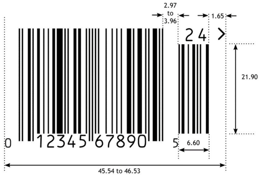
Abbildung 5.2.6.6-5. UPC-A Strichcode mit zweistelligem Zusatzsymbol
