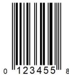
Abbildung 5.2.2.4-1. UPC-E Strichcode (Verschlüsselung von "012345000058" durch Nullunterdrückung)
