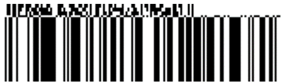
Abbildung 5.11.8-8. GS1 DataBar Expanded Symbol mit einer 4-spaltigen CC-A Komponente
