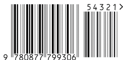
Abbildung 5.2.2.5.2-2. EAN-13 Strichcode mit einem fünfstelligen Zusatzsymbol
