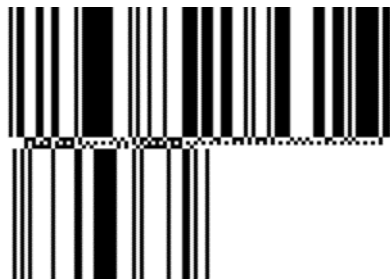
Abbildung 7.8.6.3-1. Beispiel eines GS1 DataBar Expanded Stacked Symbols mit verketteten Daten
