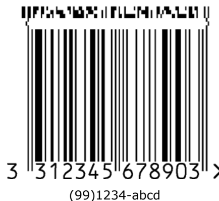
Abbildung 5.11.8-1. EAN-13 Symbol mit einer 4-spaltigen CC-A Komponente
