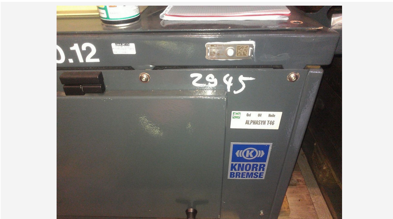
Abbildung 2-6: Beispiel einer RFID-basierten Kennzeichnung an einer sicherheitsrelevanten Komponente angebracht
