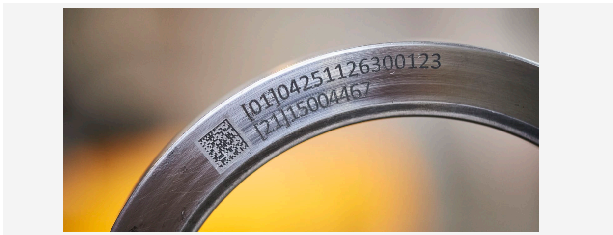
Abbildung 4-5: Beispiel eines gelaserten Kugellagers mit serialisierter GTIN im GS1 DataMatrix
