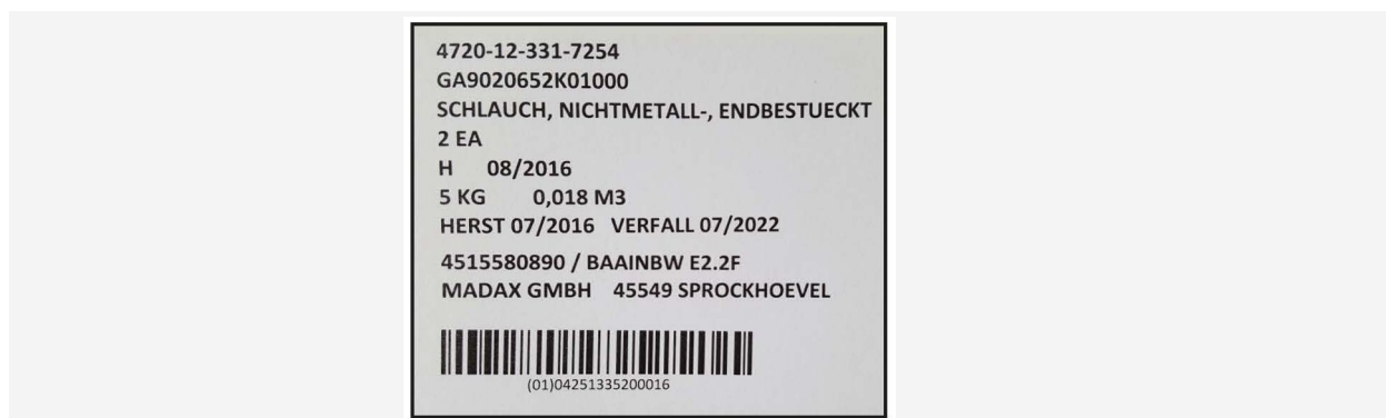
Abbildung 4-2: Beispiel einer gedruckten Produktetikette mit GTIN im GS1-128
