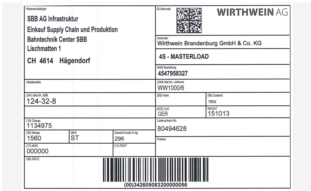
Abbildung 4-3: Beispiel einer Logistiketikette mit SSCC und GS1-128
