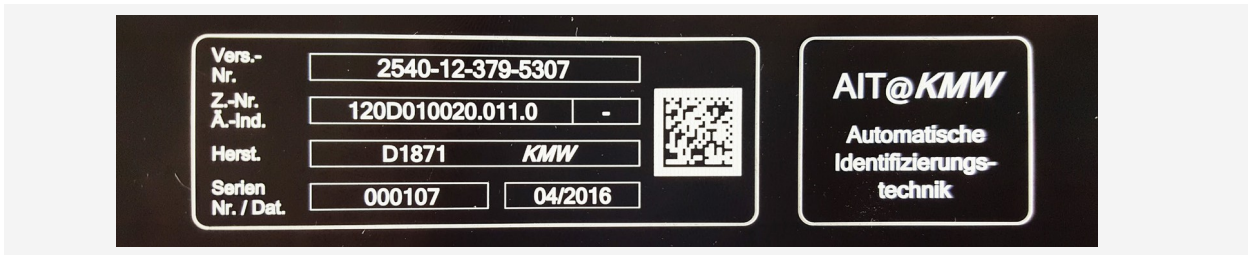
Abbildung 4-4: Beispiel einer gelaserten Produktetikette mit serialisierter GTIN im GS1 DataMatrix
