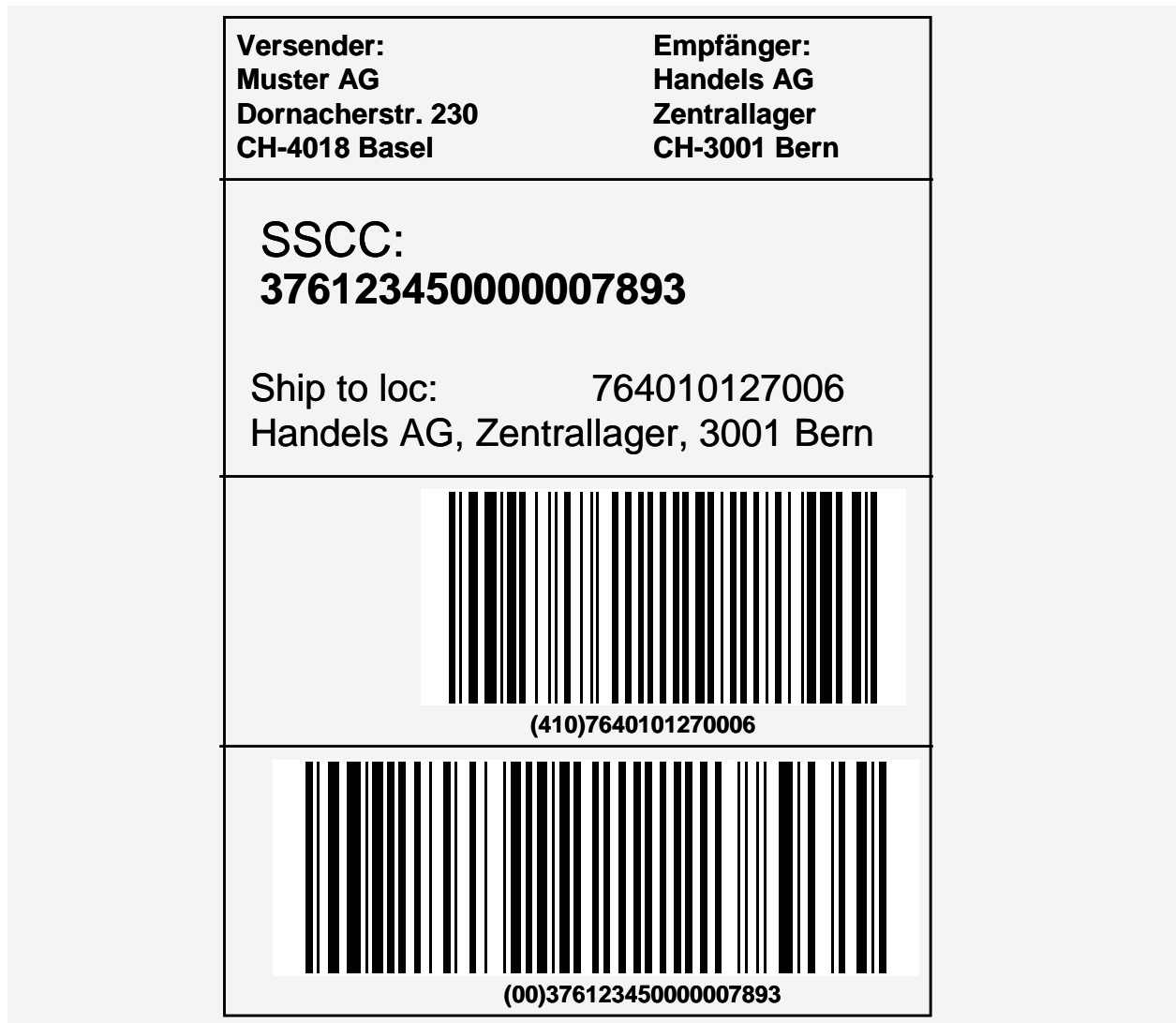
Abbildung 8: Beispiel eines Logistiklabels (Format DIN A6) mit zusätzlich verschlüsselter GLN des Empfängers (Ship to loc)
